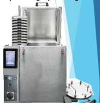
NOTA: Este equipo requiere un suministro de presión de 22 bares por lo que se recomienda un tanque usuario para suministro de aire extra seco comprimido a una presión de 22 o 23 bares pudiendo contratarlo con de este material. Accesorio: Horno de desgasificación por vacío. TOUCH SCREEN. Se utiliza para recuperar las muestras envejecidas con el PAV.
